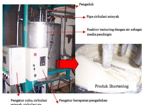
Gambar 1. Alat texturing kapasitas 50 kg/batch (Alat ini dirancang bangun oleh PPKS)
